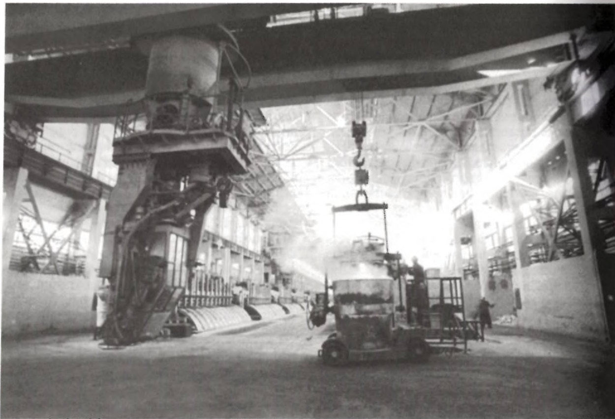
СаАЗ. Выпуск алюминия из вакуум-ковша. Июль 1981 г.
