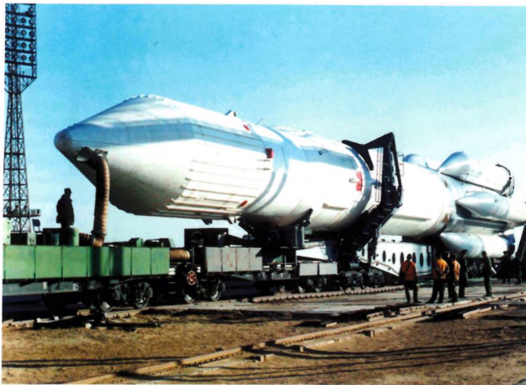
Подача системы «Протон» на стартовую позицию по специальным рельсовым путям. 1987 г.
