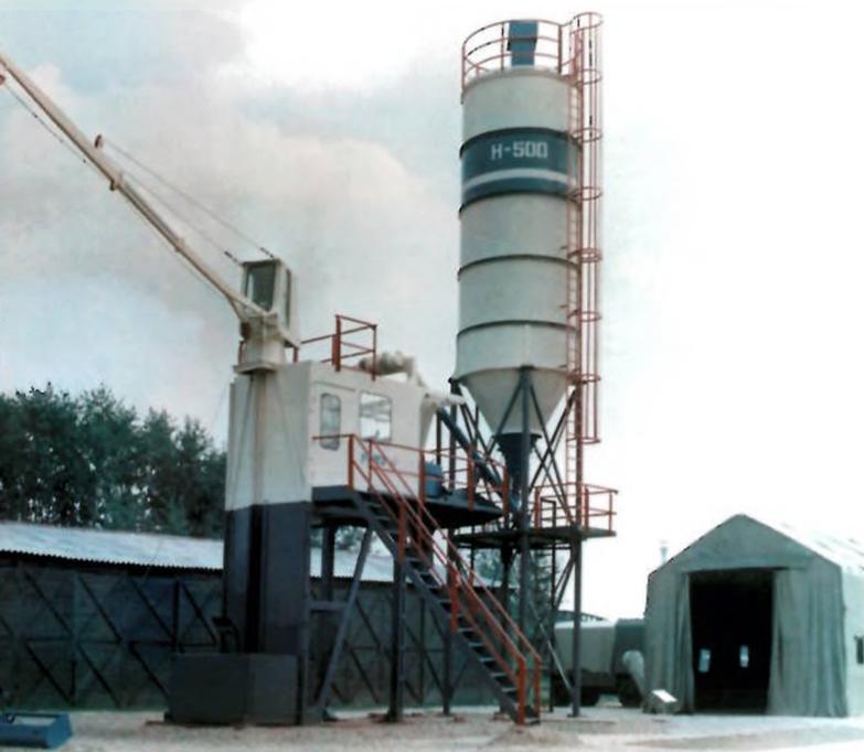
Автоматизированная бетоносмесительная установка Н-500, изготовленная по кооперации с фирмой «Штеттер» (Германия). 1986 г.
