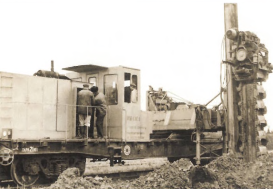
Вертикальный котлованокопатель КУ-1 на испытаниях 1983 г.
